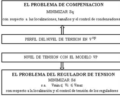
Fig. 4.1 Diagrama de bloques del modelo reactivo desacoplado
